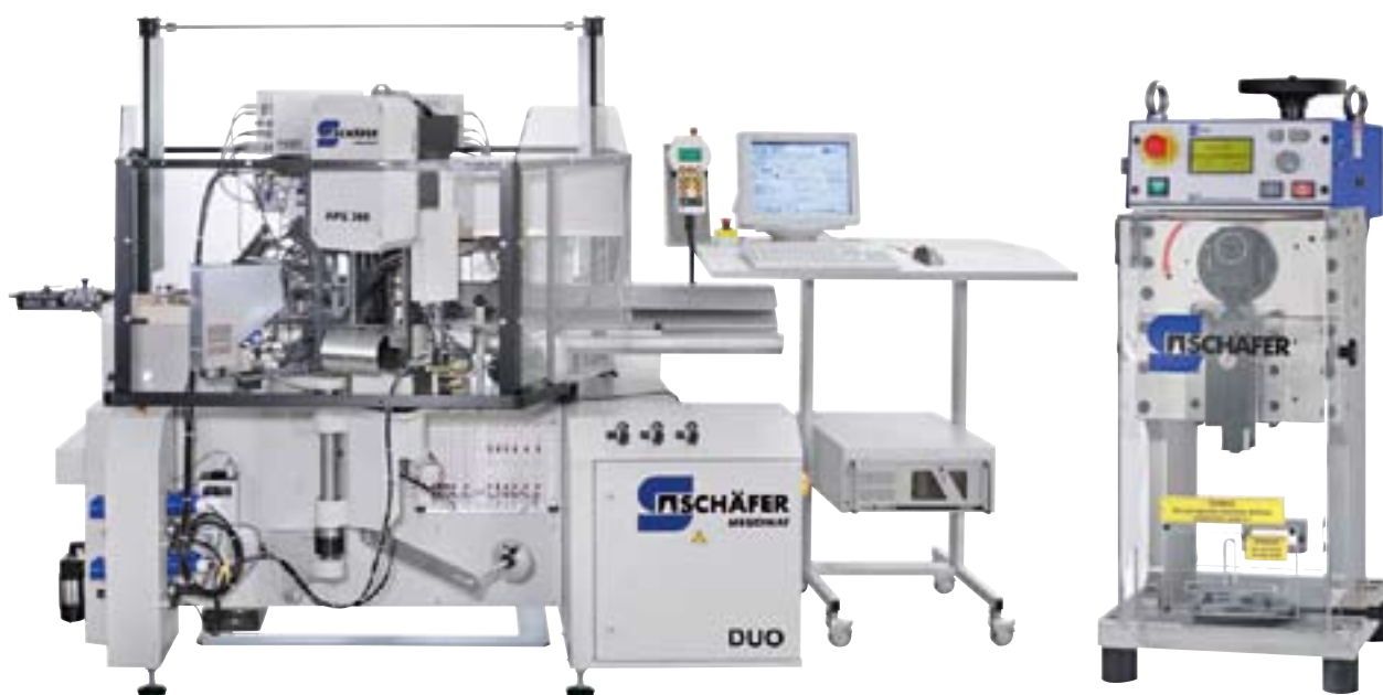
A la izquierda, máquina engarzadora completa, a la derecha, prensa engarzadora.
